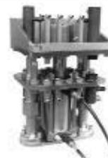
Втяжного типа соединение и разъединение с нулевой суммой сил при помощи втягивающего привода
